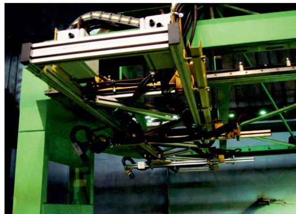
Система измерения геометрических параметров прокатных листов
