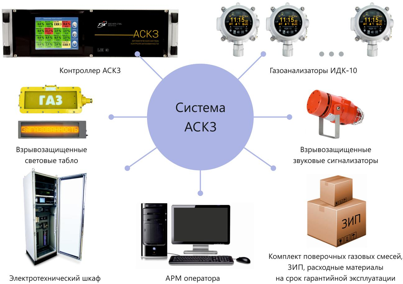
Контроллер ACKZ обладает полноценным WEB интерфейсом, с любого ПК оператор может получить доступ к информации, настройке и визуализации.
