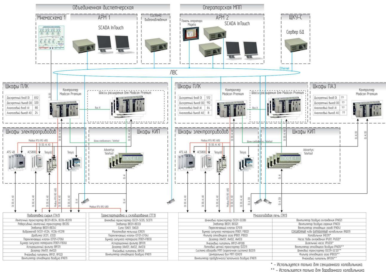
Система предназначена для обеспечения оперативного измерения и контроля технологических параметров, предупредительной и предаварийной сигнализации, отображения данных о ходе технологического процесса, автоматического управления и ПАЗ.
