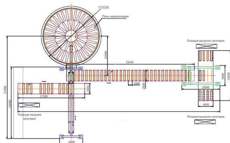
Заготовки, поступившие на участок нормализации, с помощью цехового подъемно-транспортного оборудования укладываются обслуживающим персоналом на базисные элементы комплекточной тележки. Комплекточная тележка предназначена для помещения четырех заготовок. По окончании загрузки тележка перемещается к передающему столу. Передающий стол приподнимает заготовки, и комплекточная тележка уходит на позицию загрузки.
