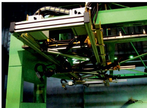
Система измерения геометрических параметров прокатных листов
