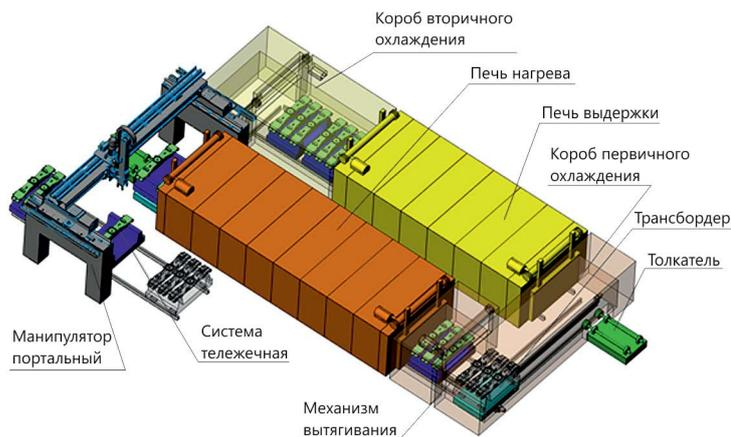
При данной технологии термообработки происходит полная фазовая перекристаллизация сталей 20ГФЛ и 20ГЛ. Измельчая зерно, снимая внутренние напряжения и уменьшая структурную неоднородность, термообработка способствует повышению пластичности и вязкости изделия по сравнению с механическими свойствами, полученными после литья.
