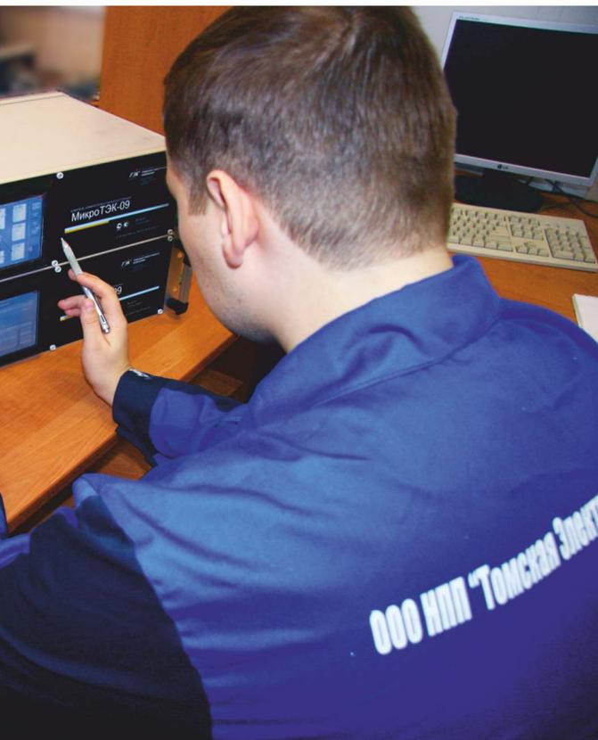
ИВК МикроТЭК является метрологически обеспеченной системой с аттестованным программным обеспечением, с методикой поверки, использующей стандартные эталоны, и с аттестованной методикой выполнения измерений.
