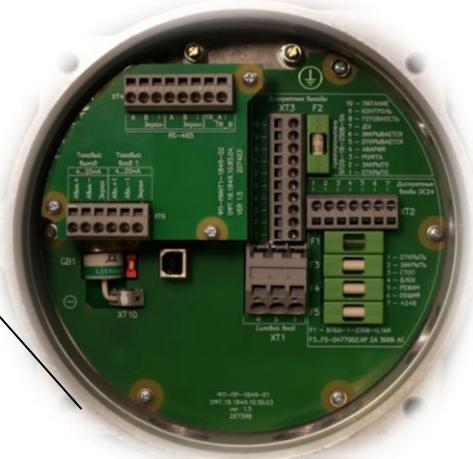
Рисунок 5 – Бокс подключения ЭРА-10 модификации по интерфейсным сигналам "18"
