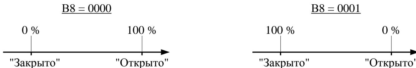
Рисунок 7 – Настройка индикации положения регулирующего элемента арматуры
